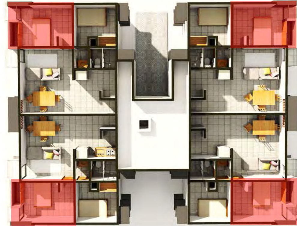
02- Planta Arquitectónica Con Ampliación
