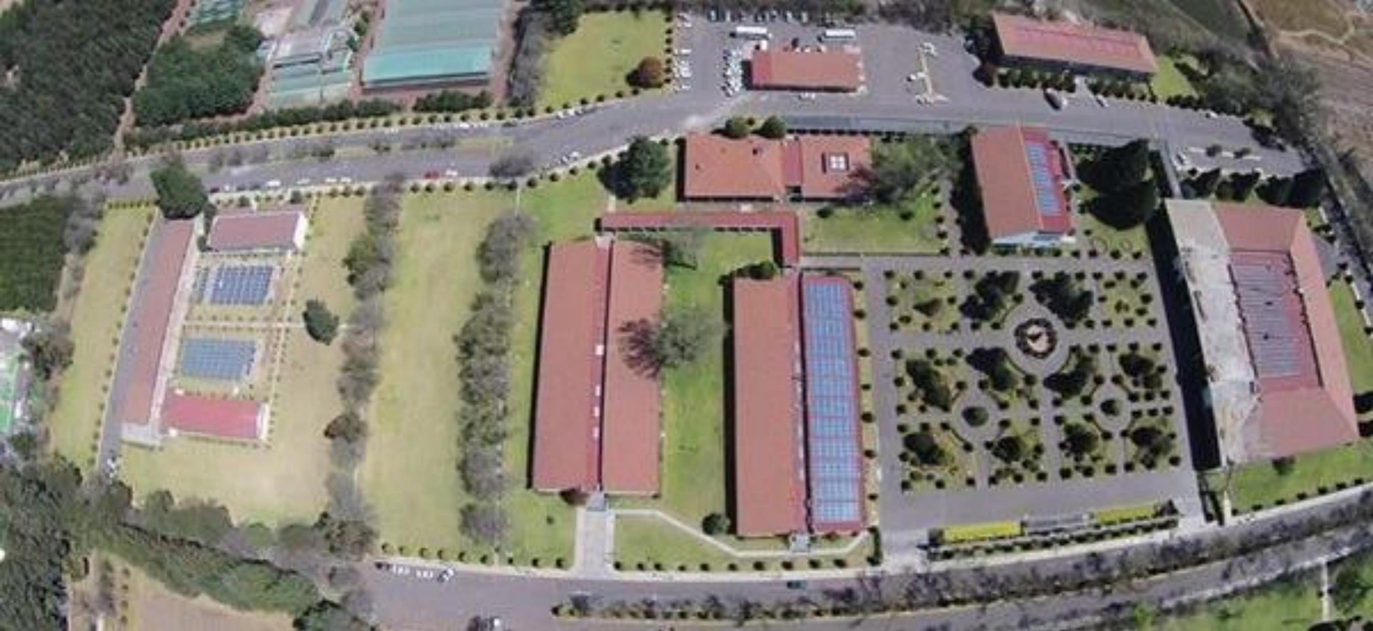
**El Sistema fotovoltaico esta comprendido por 652 paneles solares (120 policristalinos y 532 monocristalinos).**
