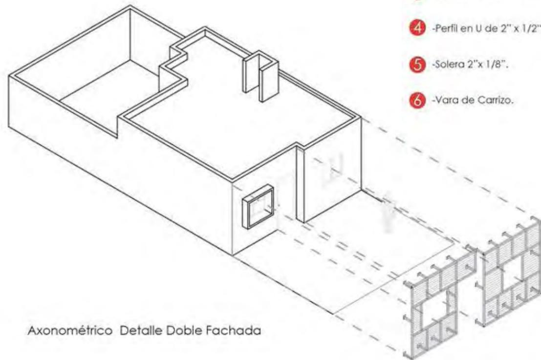
Axonométrico Detalle Doble Fachada
