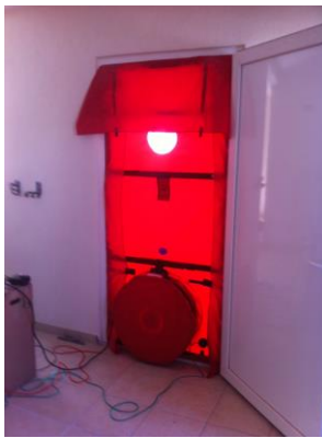
Imagen 9.- Equipo Blower Door. Fuente propia.
