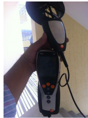
Imagen 24.- Anemómetro termómetro. Fuente propia.
