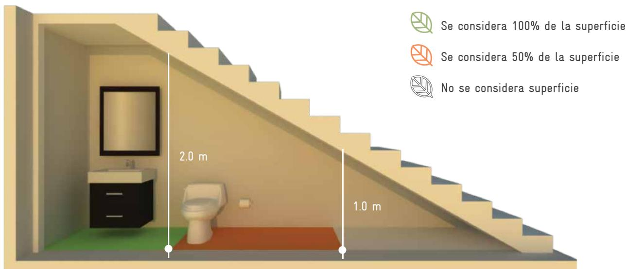
Figura C. Ejemplo de áreas a considerar para el cálculo de la SRE en áreas bajo escaleras, por ejemplo un medio baño.
