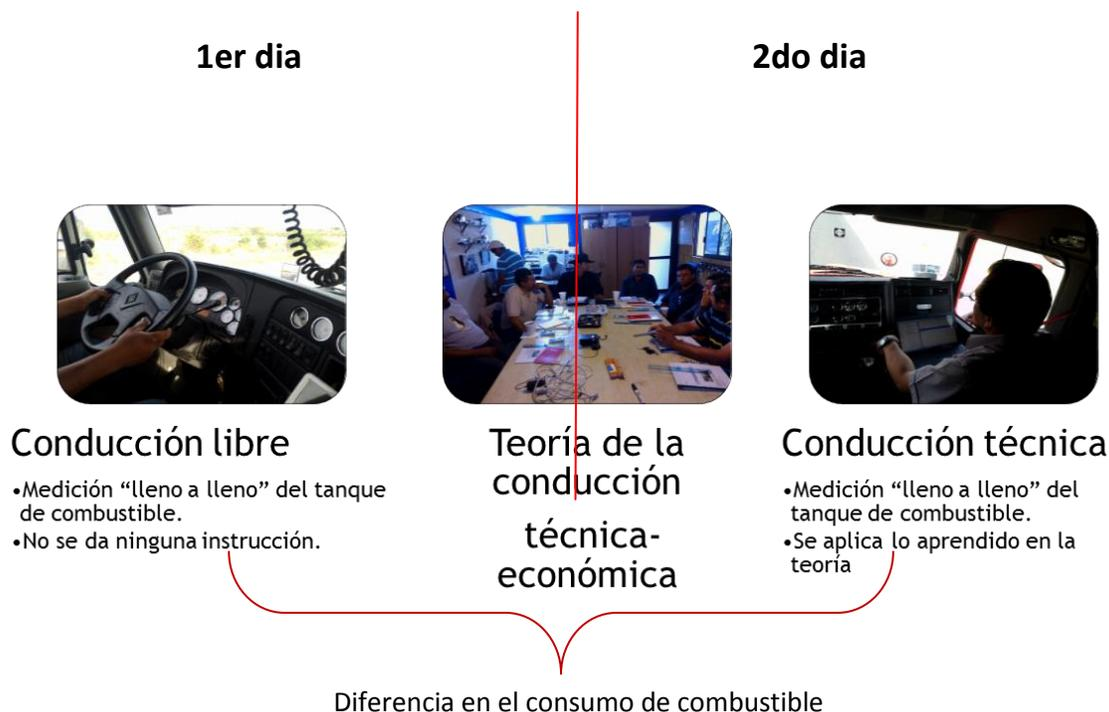
**Fig. 1 Esquema de capacitación propuesto para los HC y PT**
