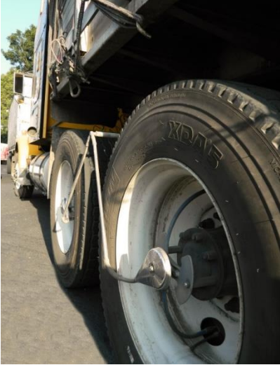
Figura 3-9. Representación del sistema de inflado automático de llantas
