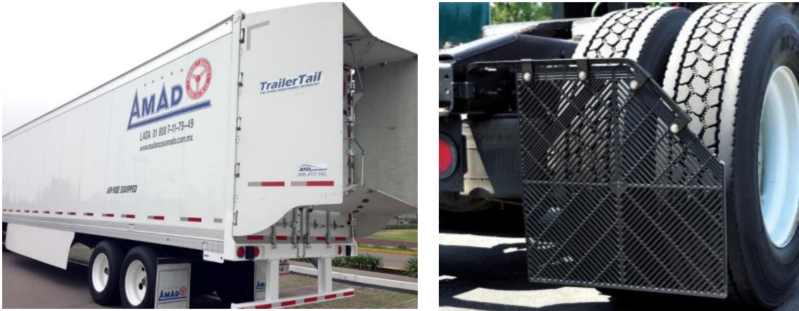
Figura 3-11. Dispositivos aerodinámicos para el tracto-camión y remolque
