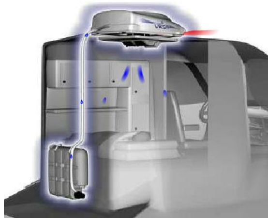
Figura 3-12. Representación de un enfriador ecológico para cabina VIESA.
