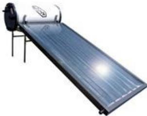
4. Carcasa: Es la encargada de proteger y soportar los elementos del colector, además de servir de enlace con el edificio por medio de los soportes. Sus dimensiones habituales son 80-120 cm de ancho; 150-200 cm de alto; y 5-10 cm de espesor. La cara expuesta al sol está cubierta por un vidrio muy fino, mientras que las cinco caras restantes son opacas y están aisladas térmicamente.
